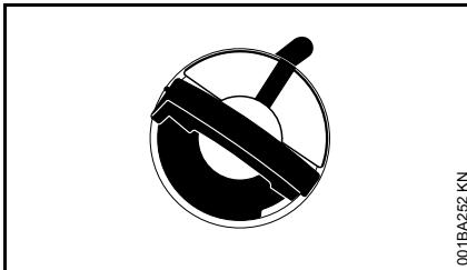
Маркировките върху капачката на резервоара и върху резервоара за масло трябва да се покрият (да съвпаднат)
