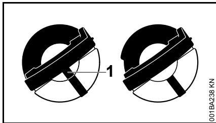
отляво: Долната част на капачката на резервоара за гориво е превъртана – вътрешната маркировка (1) се прилокира /съвпада с външната маркировка
