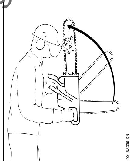
При обратен удар ("кик-бек") трионът отскача внезапно и неконтроликуемо към работещия с него.
