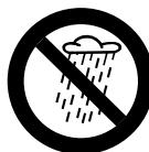
Не работете с апаратата при дъжд, а също и при мокри или много влажни местности – задвижващият двигател не е защитен срещу намокряне.
